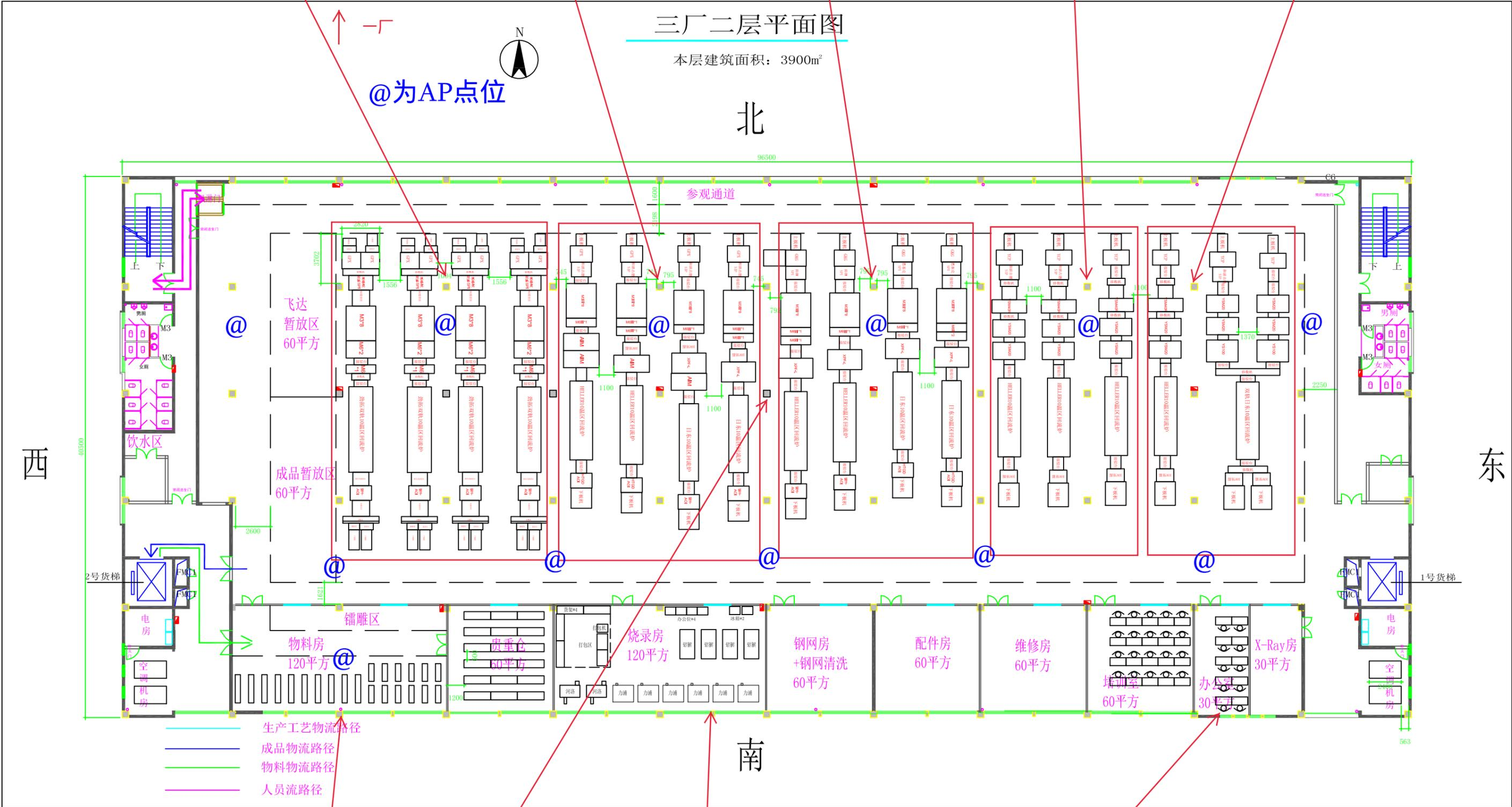
此处安装6u机柜1个，覆盖物料、镭雕、贵重的有线设备
